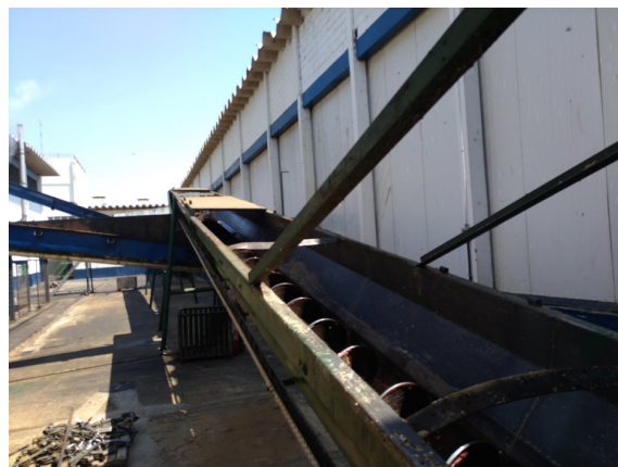
Foto 08. Rosca transportadora de subprodutos para a graxaria.
