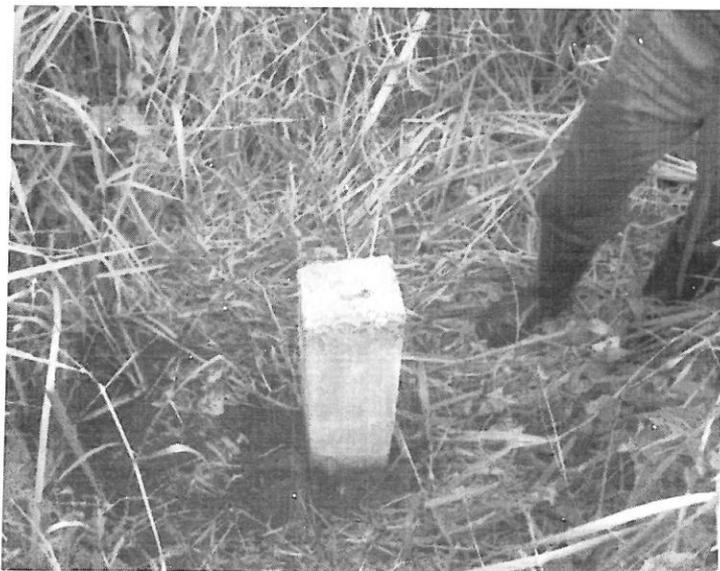
Figura 02 – Exemplo de Marco Topográfico de Terreno – MTT
