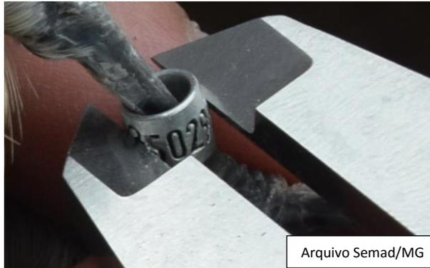
Figura 1 - Visualização da medida do diâmetro externo da parede
