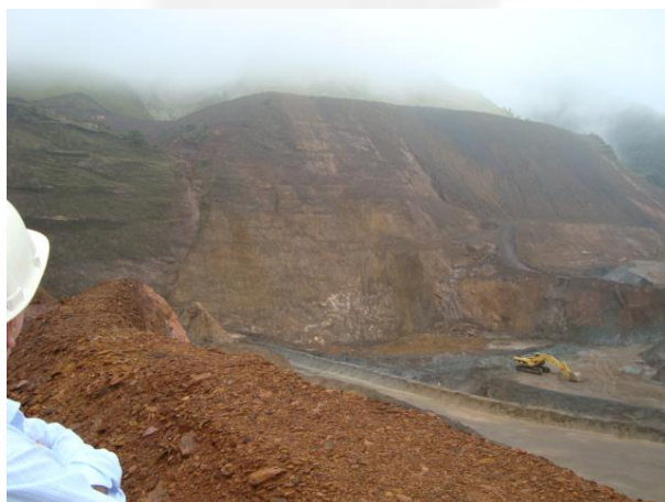
Foto 03. Vista da cava em processo de geometrização em sentido descendente (parte do talude superior encoberto pela neblina). !
