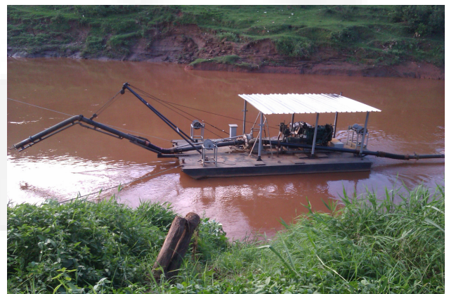
Foto 04. Dragagem usada na extração da areia e cascalho
