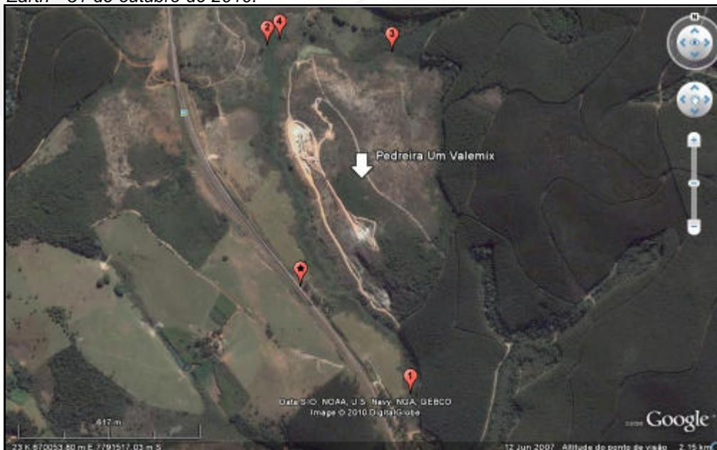
**Imagem 02.** Detalhe da imagem anterior: cava paralizada (ao sul), em atividade (ao centro); instalações a noroeste; cursos d'água e linha ferroviária ao oeste e norte, área de pastagem no entorno, monocultura de eucalipto na margem direita e pontos de monitoramento sísmográfico (asterisco) na linha ferroviária e hídrico a montante (1 e 2) e a jusante do (3 e 4) do empreendimento.
