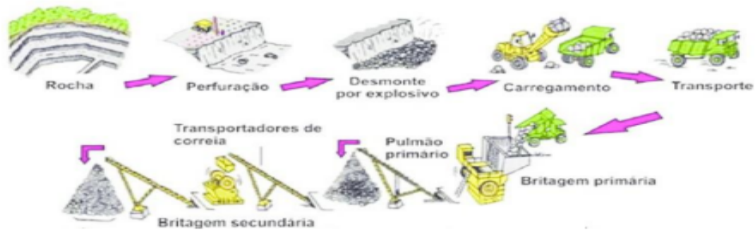
Figura 03: Fluxograma do processo produtivo.
