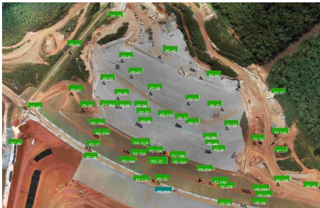
Figura 2-2 - Localização dos Piezômetros (PZ) e Inclínômetros (INC). Fonte: Informações complementares, 2023
