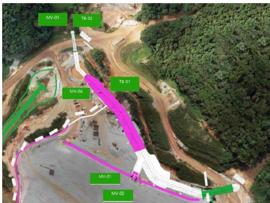
Figura 2-3 - Localização dos Medidores de vazão (MV) e Turbidímetros (TB). Fonte: Informações complementares, 2023
