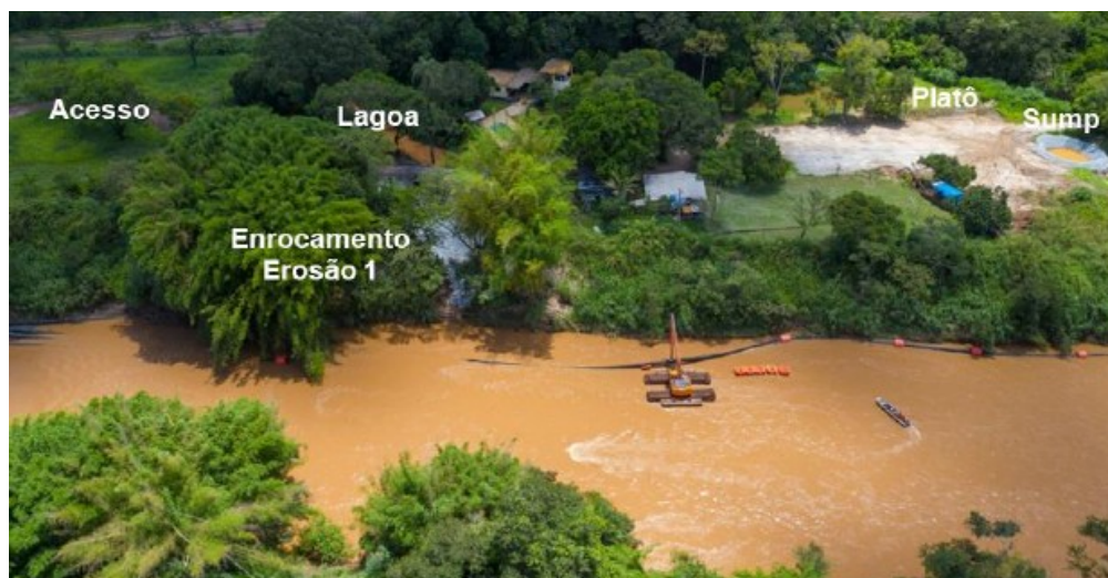
Figura 51: Vista aérea da propriedade mostrando o enrocamento da Erosão 1, lagoa desassoreada, platô formado e o Sump. (Fonte: Vale - IC, nov/2021).
