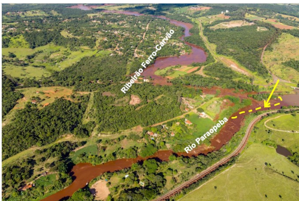
Figura 91: Confluência do ribeirão Ferro-Carvão com rio Paraopeba. Nota-se sedimentos formando um cone de detritos - linha amarela tracejada. (Fonte: Vale, 2019 - Vol. III EIA).
