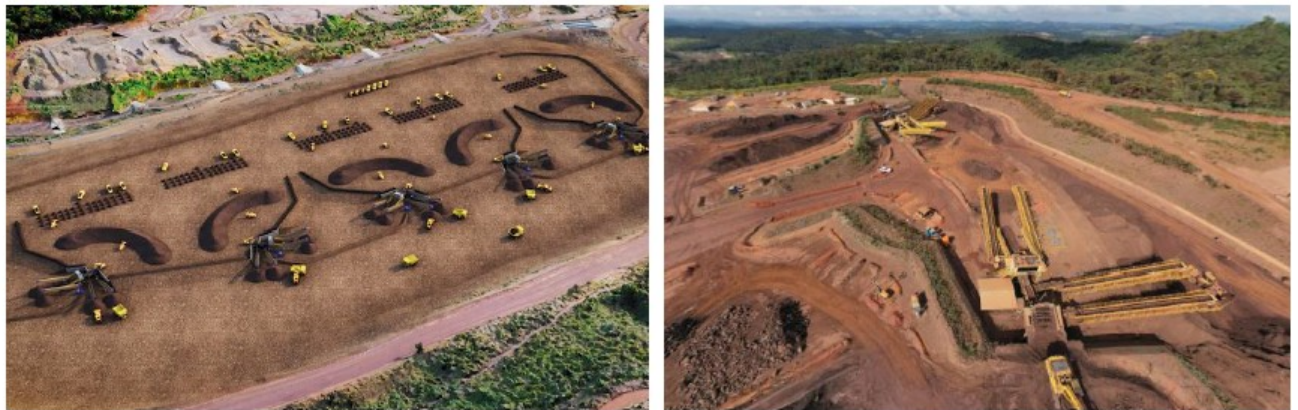
Figura 25: Arranjo da instalação das cinco unidades móveis de peneiramento na região do TCF e Estações de buscas em operação (Fonte: Vale - PMR maio/2023).
