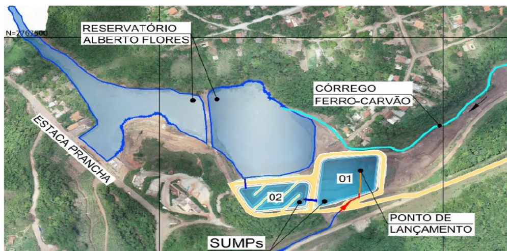
Figura 34: Configuração do sump e chicanas a montante da EP-01, onde ocorre a disposição do material dragado no rio Paraopeba, desde 09/03/2022. Fonte: Vale - Plano de Monitoramento da Operação de Dragagem - Revisão 22, Anexo 16 – PCA, jan/2023).
