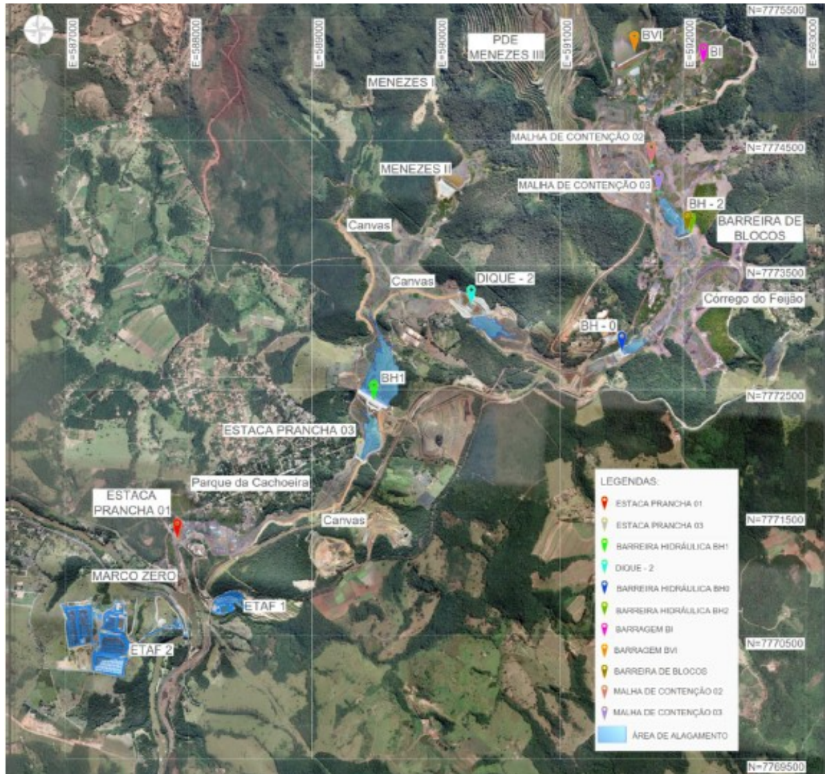
Figura 6: Localização das estruturas de contenção de rejeitos, canal Concrete Canvas e ETAF 1 ao longo do ribeirão Ferro-Carvão. (Fonte: Vale - Plano de Manejo de Rejeito, maio/2023) .
