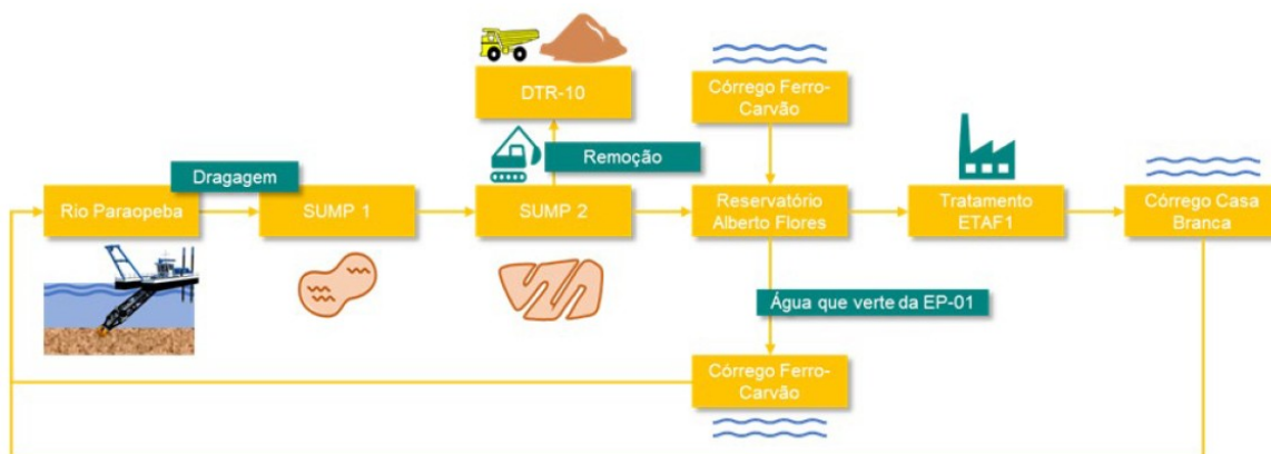
Figura 111: Fluxograma para a disposição do rejeito removido do rio Paraopeba. (Fonte: Vale - Plano de Monitoramento da Operação de Dragagem - Revisão 22, janeiro/2023).
