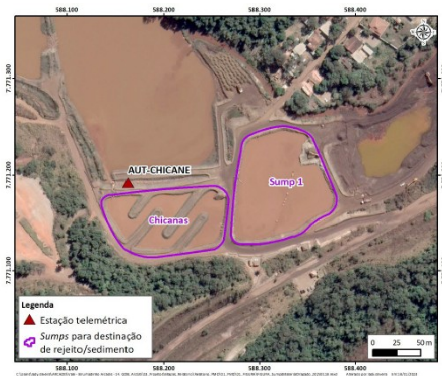
Figura 112: Localização do sump 1, chicanas (sump 2) a montante da EP-01 e reservatórios. (Fonte: Vale - Plano de Monitoramento da Operação de Dragagem - Revisão 22, janeiro/2023).
