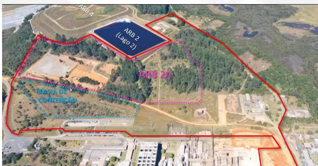
Figura 3 – Imagem aérea com indicação da área prevista para implantação da ARB 2A (em rosa) e de suas estruturas de apoio (em vermelho), contemplando a área prevista para implantação da bacia de contenção de águas pluviais (em azul).
