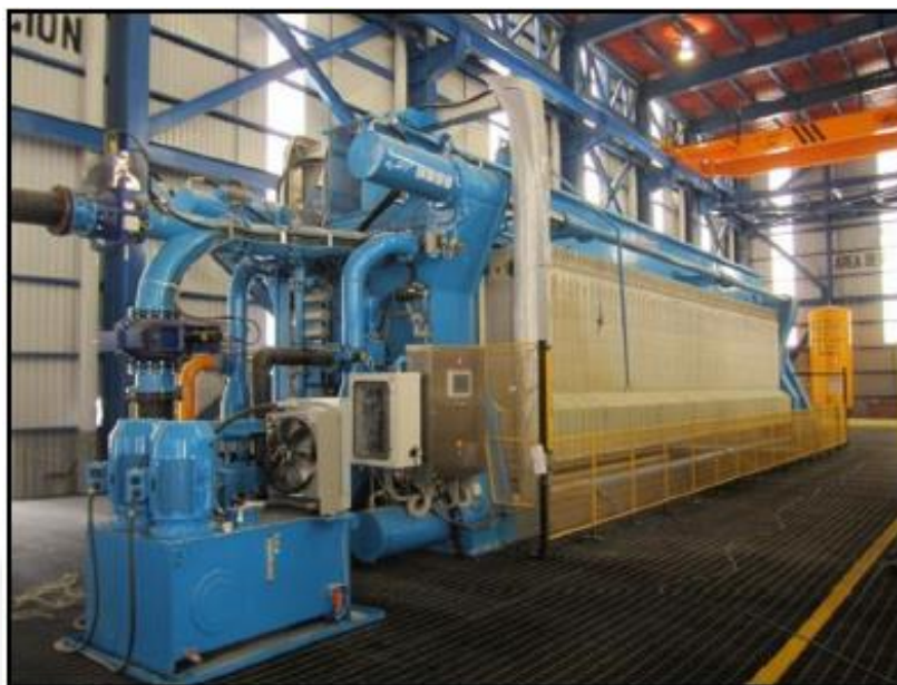
Figura 5 - Filtro similar ao proposto para a instalação de filtragem em licenciamento.
