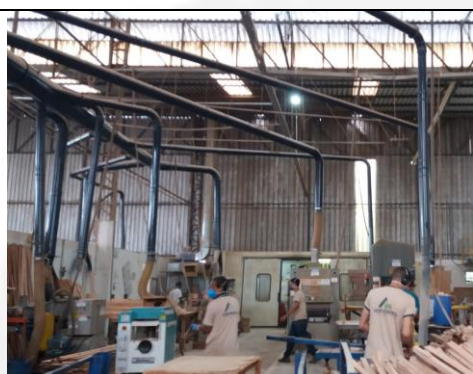
Figura 01: Setor de beneficiamento da madeira com respectivos sistemas de controles.
