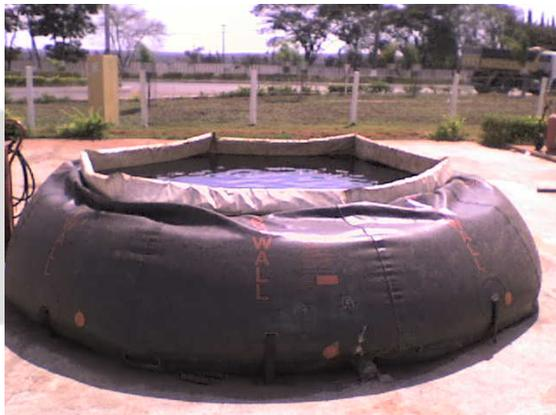
**Foto 02.** Bolsa de água utilizada para combate a incêndio.
