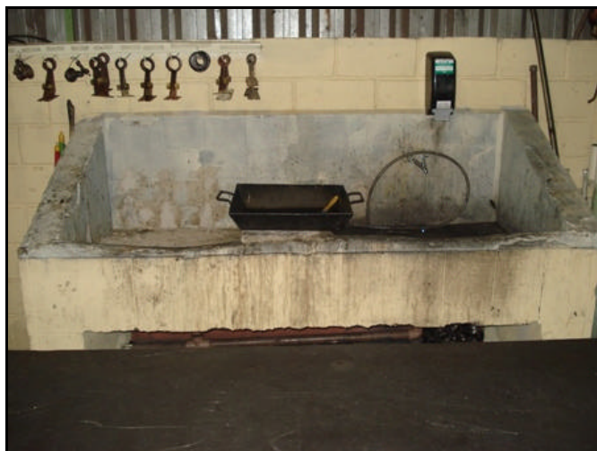
Foto 05. Tanque de lavagem de peças.
