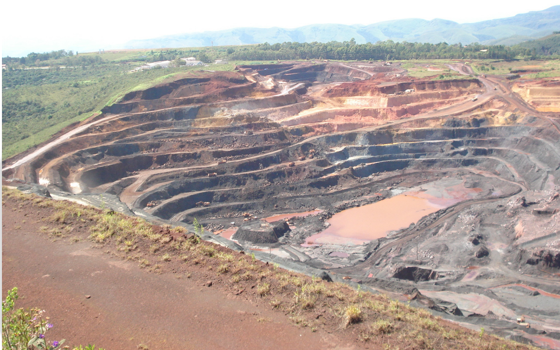
Cava da Mina de Capão Xavier Drenagem direcionada para dentro da cava.
