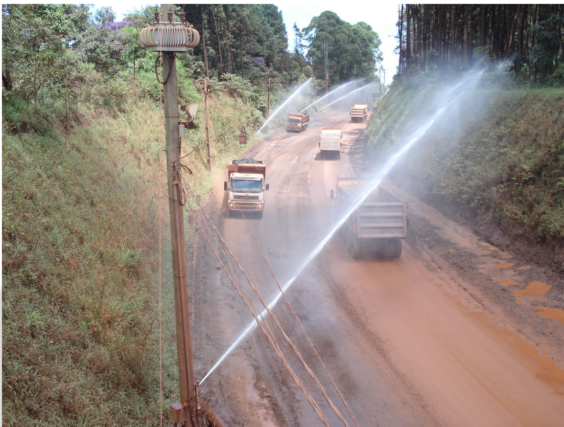
Estrada que liga a Mina Capão Xavier a Mina da Mutuca. Aspersão fixa
