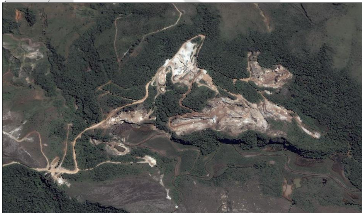
Imagem 02. Detalhe do empreendimento: UTM e pátio de estocagem de minério ao norte, pilha de estéril ao nordeste, cavas (antiga e atual) ao sul e sudeste. (Fonte: Google Earth / Março de 2009)
