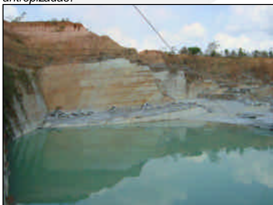
Foto 03. Vista da cava com parte preenchida com água pluvial para recirculação no corte da rocha.
