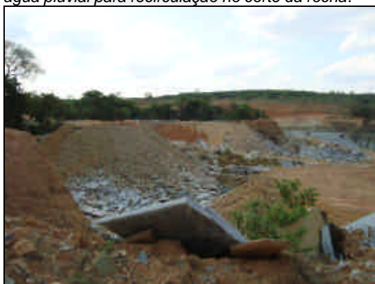
Foto 05. Prática do "bota-dentro" na cava em parte exaurida da jazida sendo adotada.
