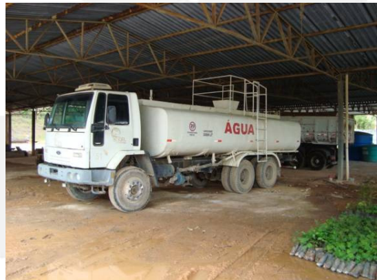
Foto 06. Caminhão-pipa utilizado na umectação de vias e pátios.
