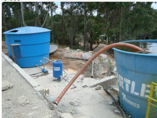
Foto 09. Sistema de abatimento de poeira usado na UTM.
