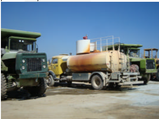
Foto 11. Caminhão -pipa utilizado na umectação das vias e pátios da pedreira.
