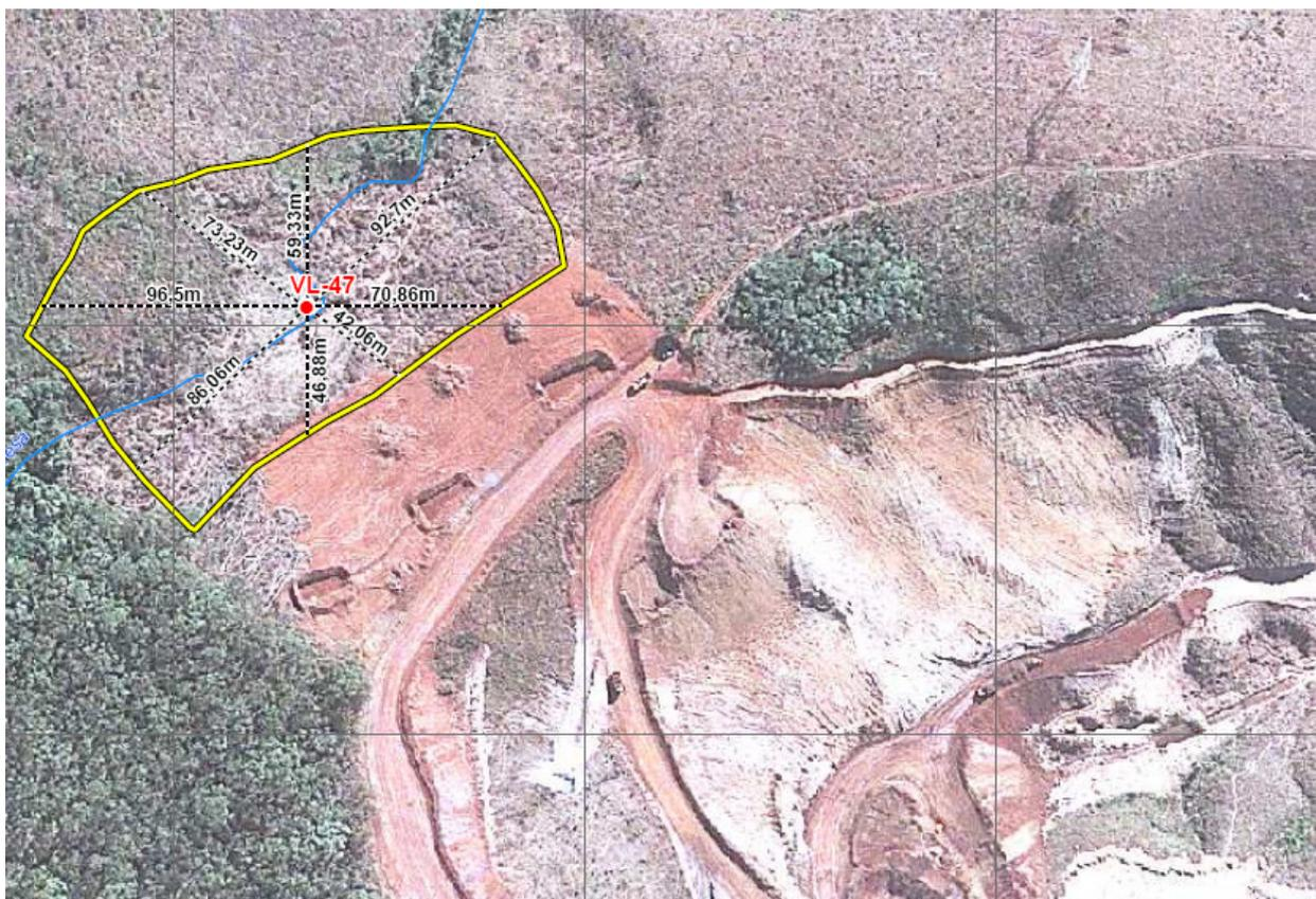
**Figura 2: Raio de proteção proposto pela empresa. Fonte: Estudos ambientais de redução de raio da VL-47**
