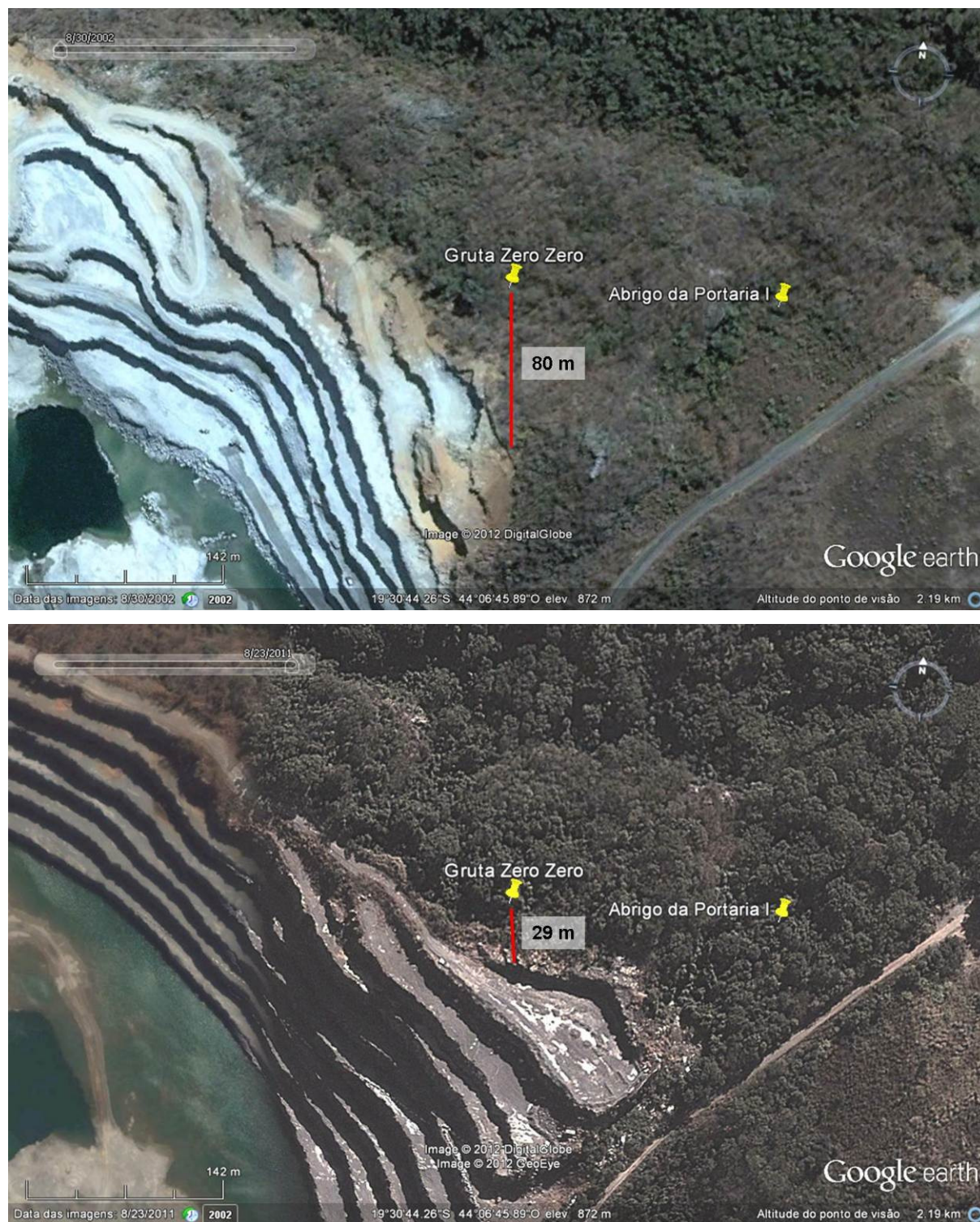
Figura 7. Avanço da cava na Mina Taquaril. Entre 2002 (imagem acima) e 2011 (imagem abaixo) a cava avançou 51 m ao norte, em direção a gruta Zero-Zero. Fonte: Google Earth; CECAV, 2011.
