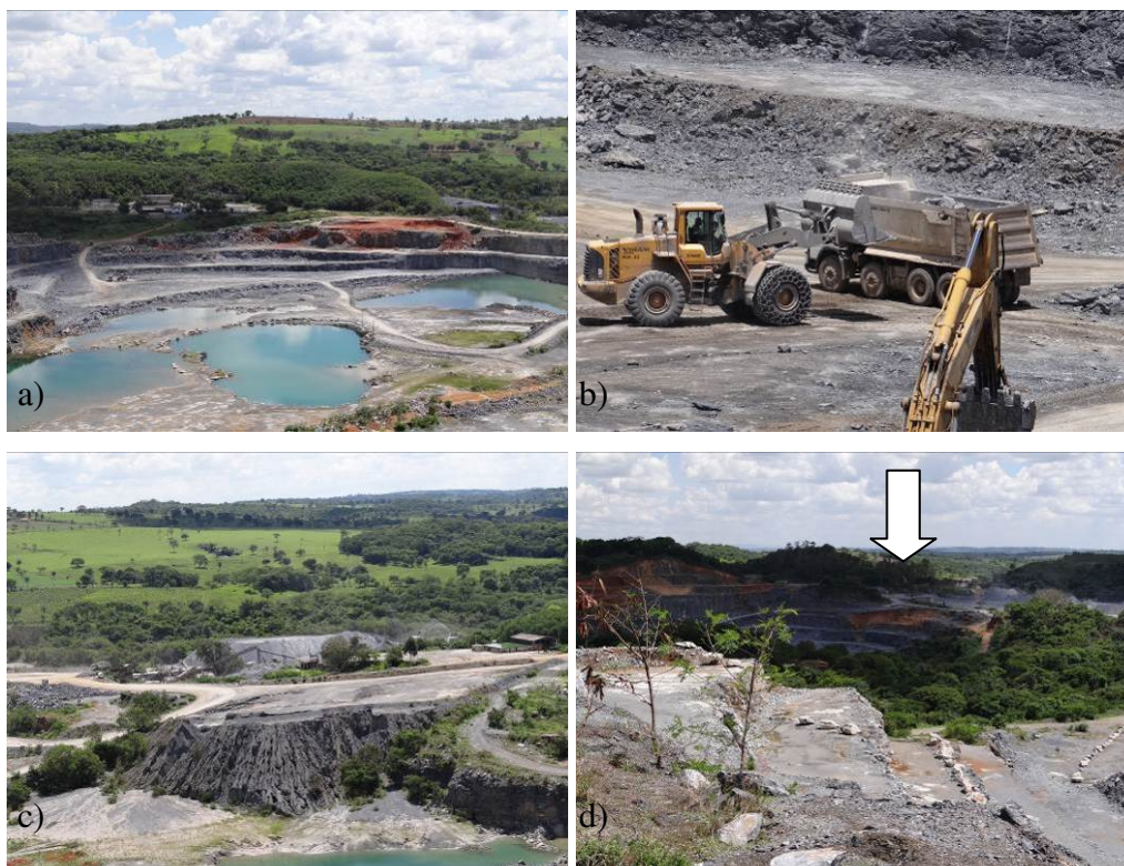
Figura 1 – Vista panorâmica da Mina Taquaril e da Área de Influência Direta: a) lavra; b) detalhe da operação da extração do calcário; c) área de britagem; e d) lavra da Mina Pedra Bonita (seta), adjacente à Mina Taquaril.
