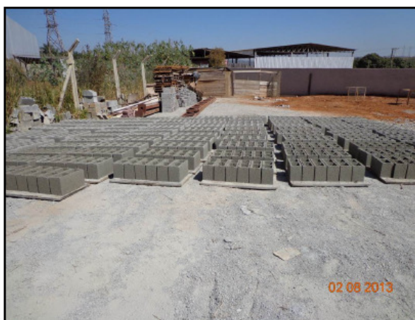
Figura 02: Área de secagem dos blocos de concreto
