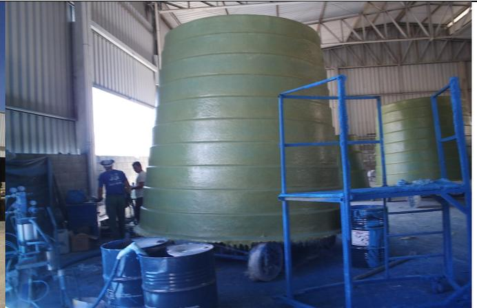
**Foto 2:** Fabricação das Caixas d' água.
