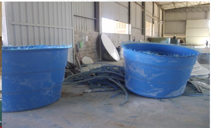
**Foto 4:** Acabamento final das caixas d' água.
