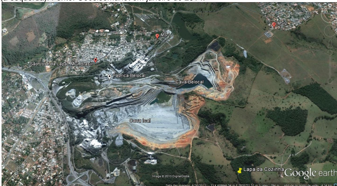
Figura 02: Detalhe da imagem anterior demonstrando as instalações (cava e britagem) da mina em relação a São José da Lapa, fábrica, empreendimento minerário (cava e demais instalações) vizinho ao sul, cavidade (Lapa da Cozinha) cadastrada no CECAV e pontos de monitoramento sísmográfico (MS 1 e MS 2) em área urbana. Fonte: Google Earth.
