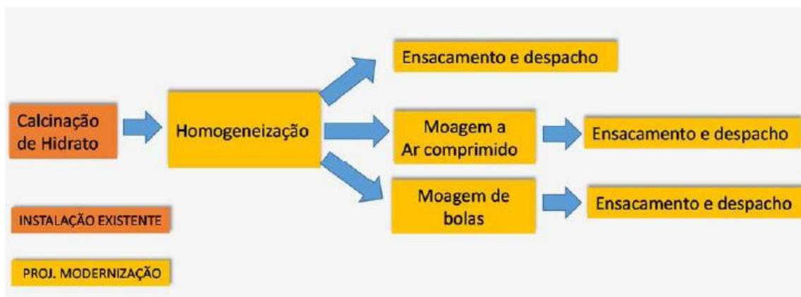
Figura 4: Fluxograma do sistema de produção de aluminas especiais.
