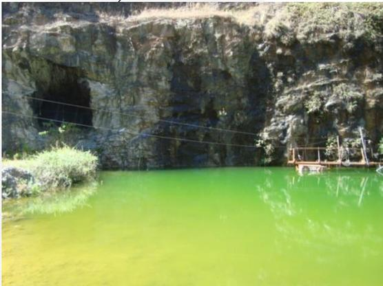
**Foto 03.** Detalhe do fundo da cava preenchida com água e chaminé para ventilação da mina subterrânea.
