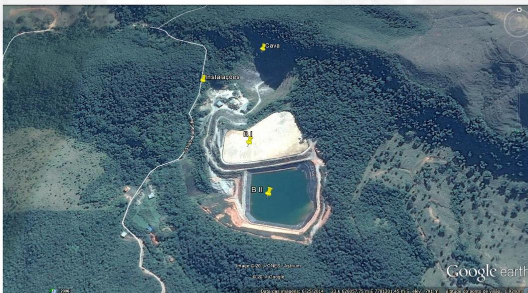
**Imagem 02.** Detalhe da imagem anterior demonstrando as estruturas do empreendimento: cava, instalações e barragens de rejeito (B I, assoreada e B II preenchida com água).
