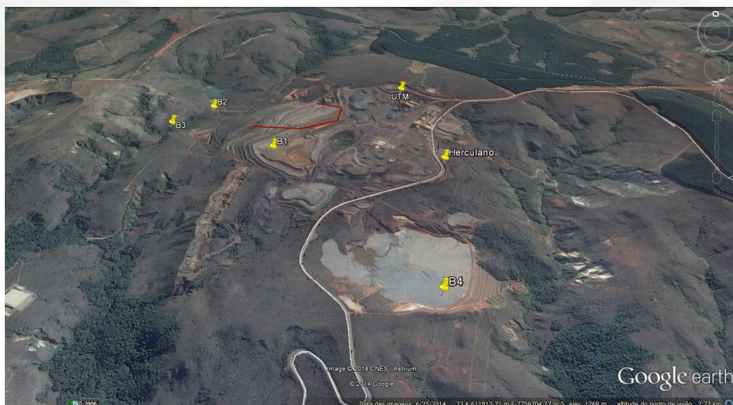
Imagem 03. Detalhe da imagem anterior demonstrando as estruturas (barragens e beneficiamento) do empreendimento, vale do afluente do córrego do Silva e local do rompimento da barragem B1 (linha em vermelho).
