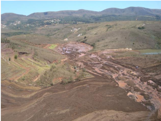
Foto 03. Vista do material do rompimento da B1 retido no vale a montante da B3.
