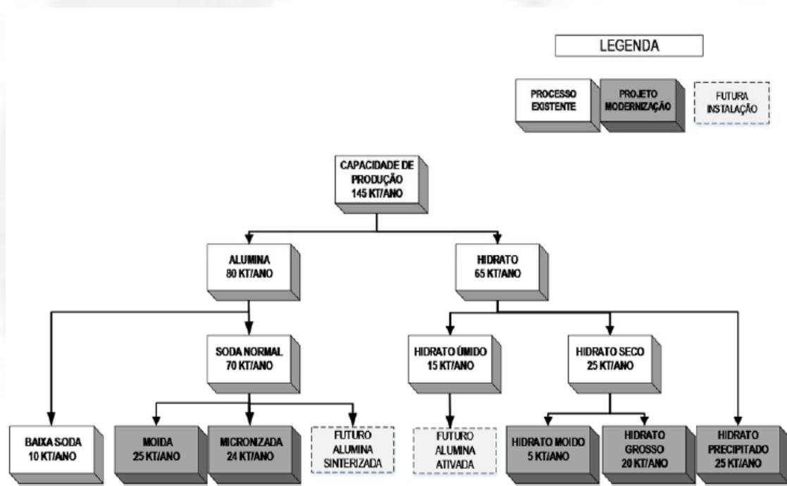
Figura 3: Estrutura analítica de produção da Hindalco prevendo a situação pós-ampliação.
