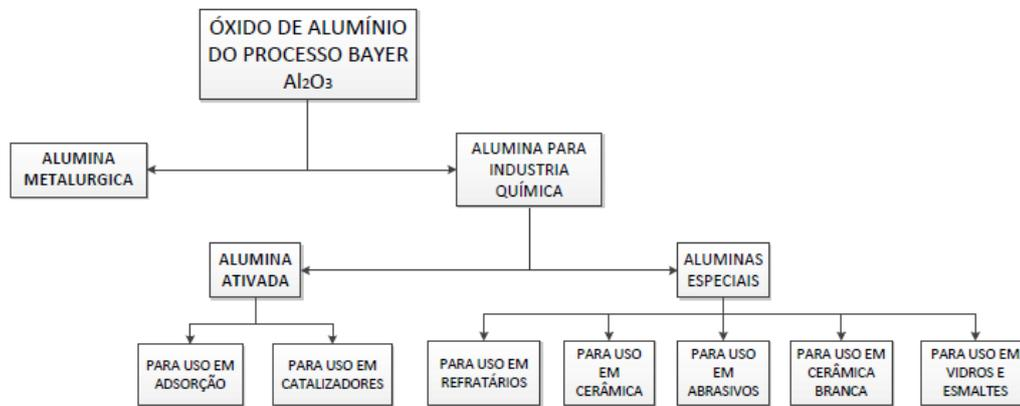
Figura 2: Aplicações potenciais para o óxido de alumínio produzido pelo processo Bayer
