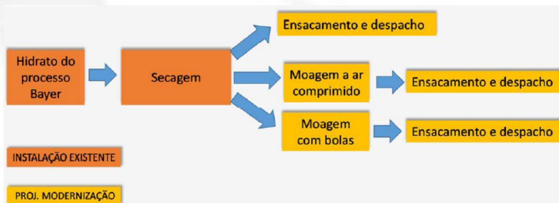
Figura 5: Fluxograma do sistema de produção de hidratos especiais.
