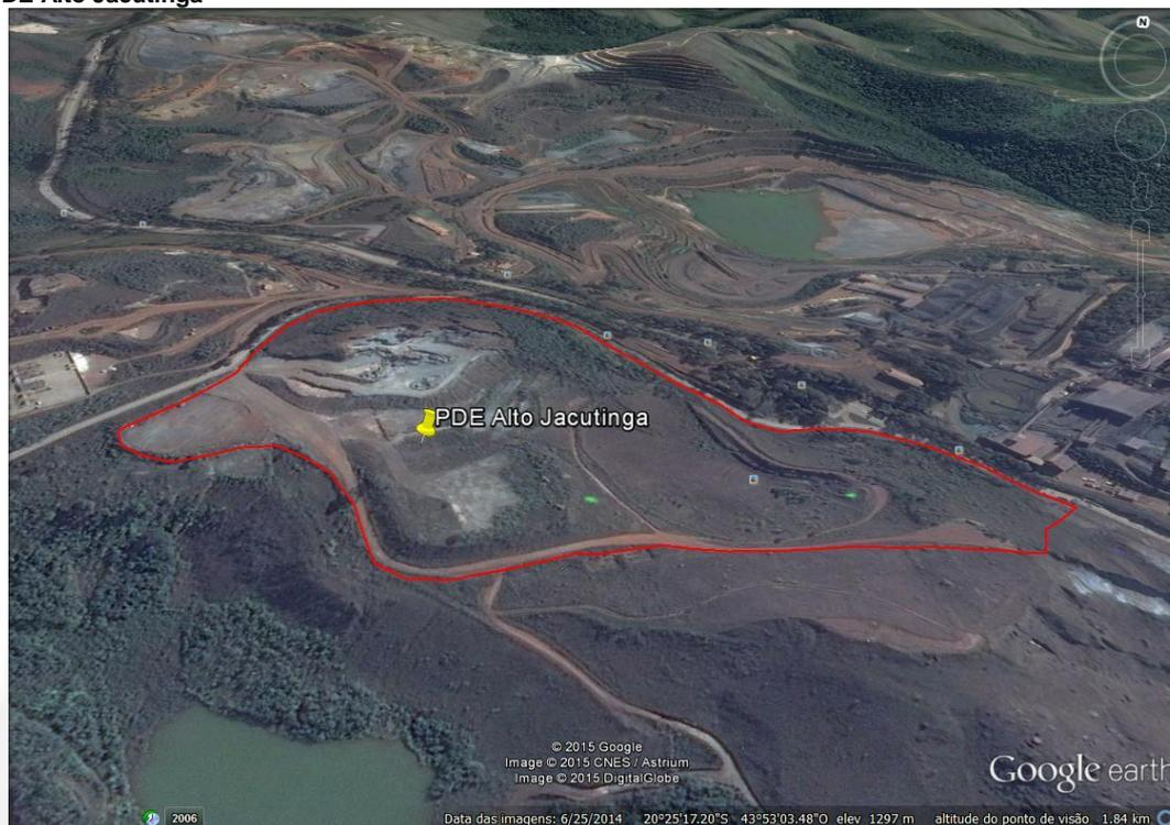
O projeto de recuperação de estéril da PDE Alto Jacutinga prevê a movimentação de 15 milhões de toneladas de *run of mine* (ROM) e processamento na unidade de beneficiamento já existente na Mina de Fábrica, sem aumento da produção atualmente licenciada.
