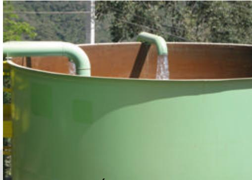
Foto 2 – Água proveniente da Barragem de Rejeito depositada em tanque para ser reutilizada no processo.
