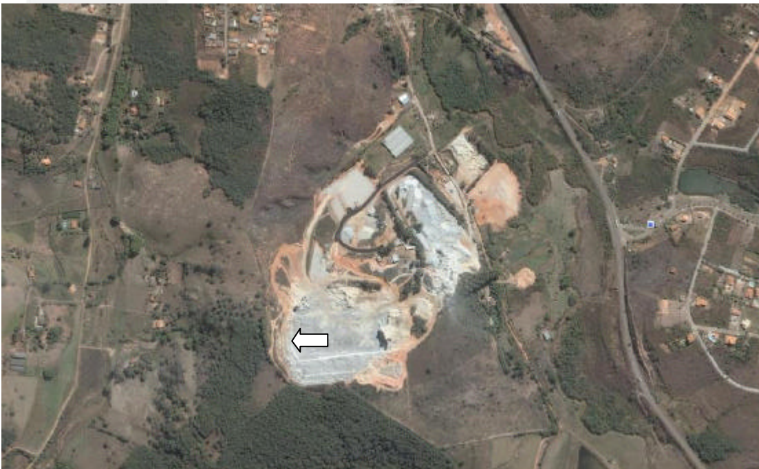
Imagem 02. Detalhe da área da imagem anterior, demonstrando o sentido do avanço da frente de lavra.
